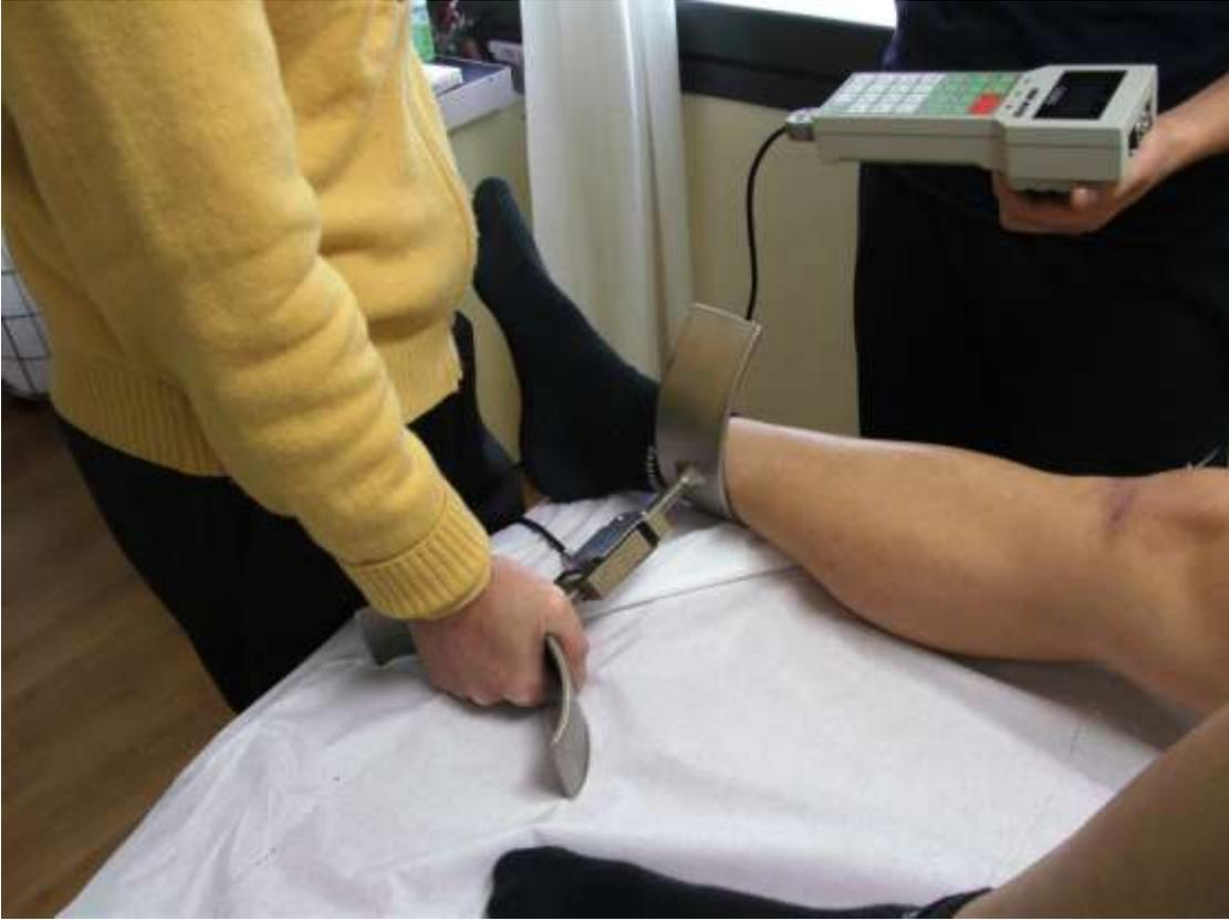
*Figura 4: il dispositivo utilizzato durante il VASDT che permette di registrare la forza isometrica degli adduttori. E' interessante notare che tramite lo stesso dispositivo è anche possibile registrare la contrazione della muscolatura adduttoria in modalità concentrica ed eccentrica*
